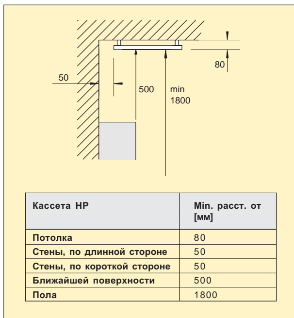
Рисунок. 2: Минимальные расстояния при установке.
