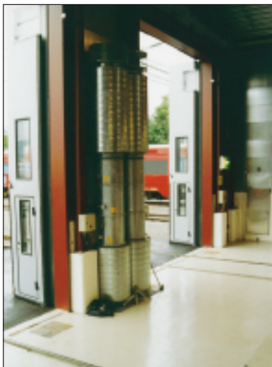
Колонна может располагаться с любой стороны проема. Для ворот большой ширины монтируются две колонны. В этом случае они могут размещаться как с одной, так и с обеих сторон воротного проема.
